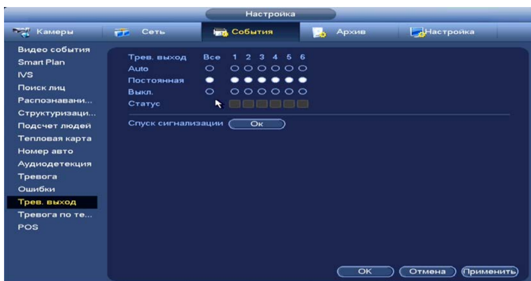
Рисунок 14.12 – Настройка записи по тревожному выходу
