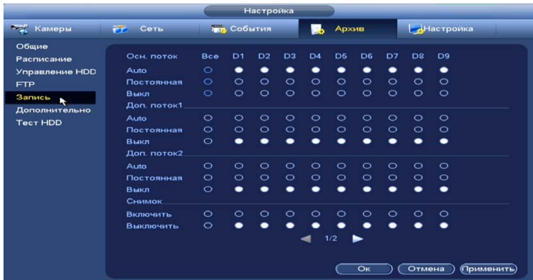
Рисунок 15.10 – Интерфейс настройки записи
