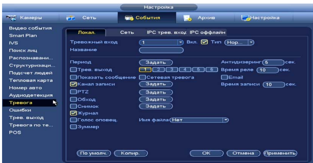
Рисунок 20.1 – Интерфейс настройки локальной тревоги
