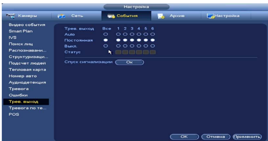
Рисунок 14.12 – Настройка записи по тревожному выходу
