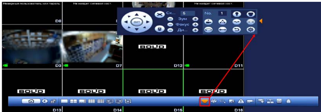
Рисунок 7.1 – Переход в меню PTZ-управления через панель навигации
