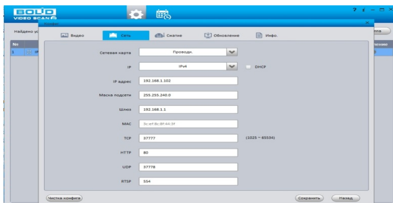
Рисунок 27.2 – Изменение IP-адреса с помощью утилиты «BOLID VideoScan»
