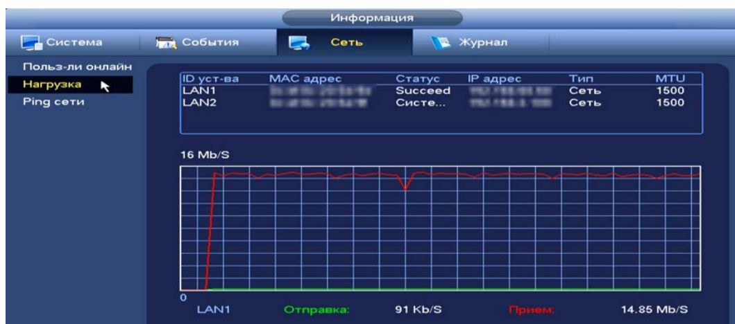
Рисунок 11.16 – Интерфейс просмотра нагрузки
