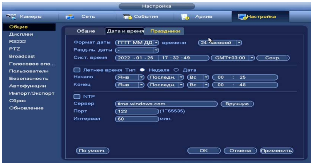
Рисунок 12.2 – Интерфейс настройки даты и времени Функции и диапазон значений расширенных настроек даты и времени представлены в таблице ниже (Таблица 12.2).
