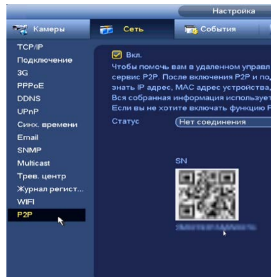
Рисунок 10.19 – QR-код добавляемого устройства
