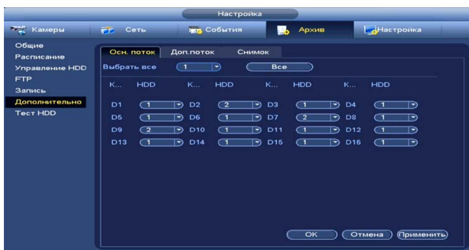
Рисунок 15.14 – Интерфейс выбора HDD для основного потока
