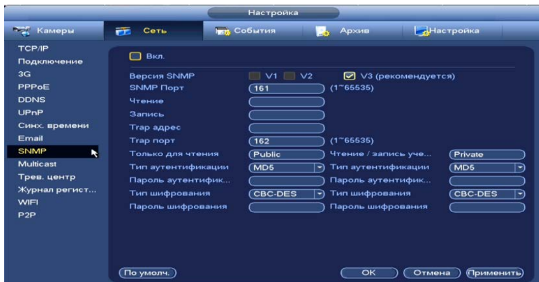
Рисунок 10.8 – Интерфейс настройки «SNMP»
