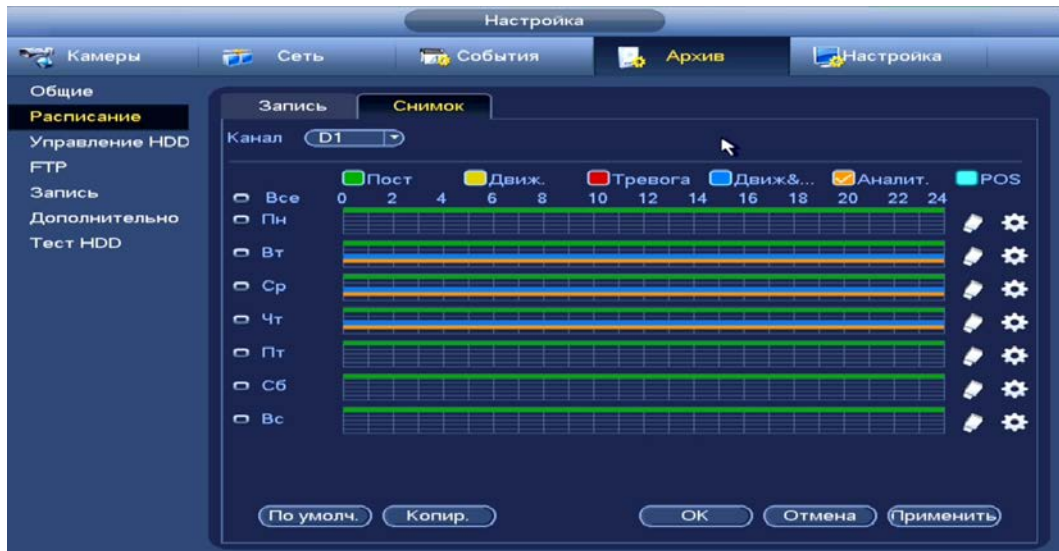
Рисунок 15.8 – Настройка расписания снимка на устройстве
