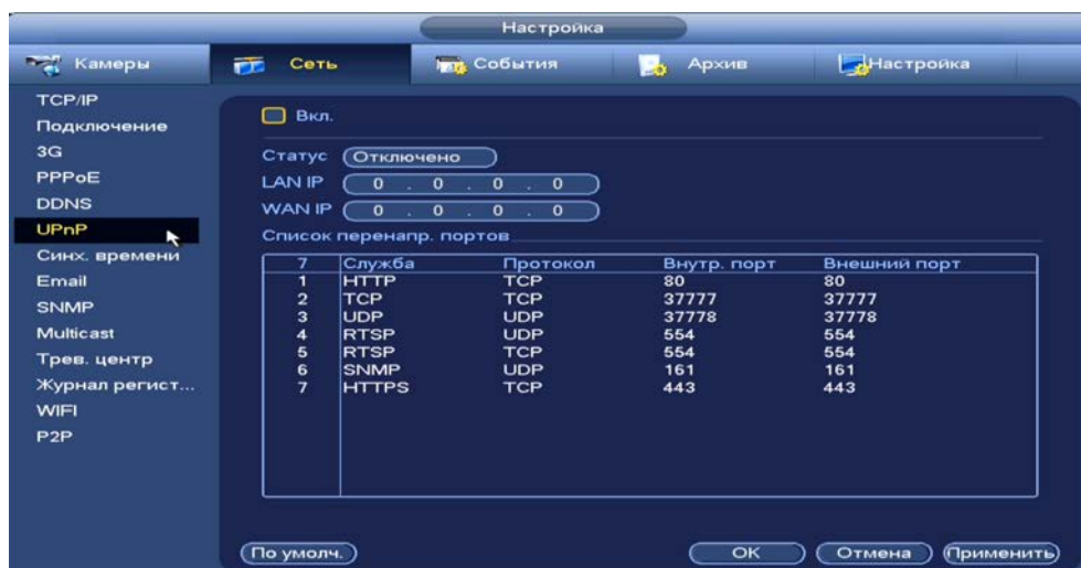
Рисунок 10.5 – Интерфейс настройки «UPnP»
