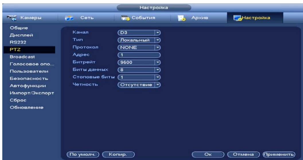
Рисунок 7.9 – Локальное PTZ подключение
