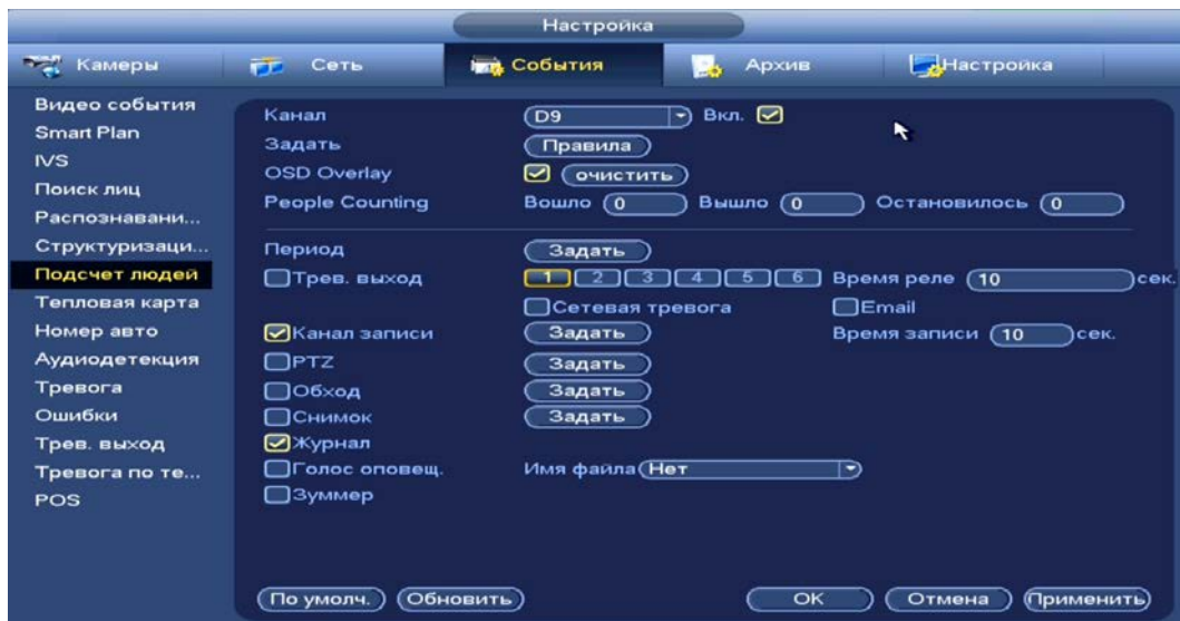
Рисунок 18.20 – Интерфейс настройки подсчета людей
