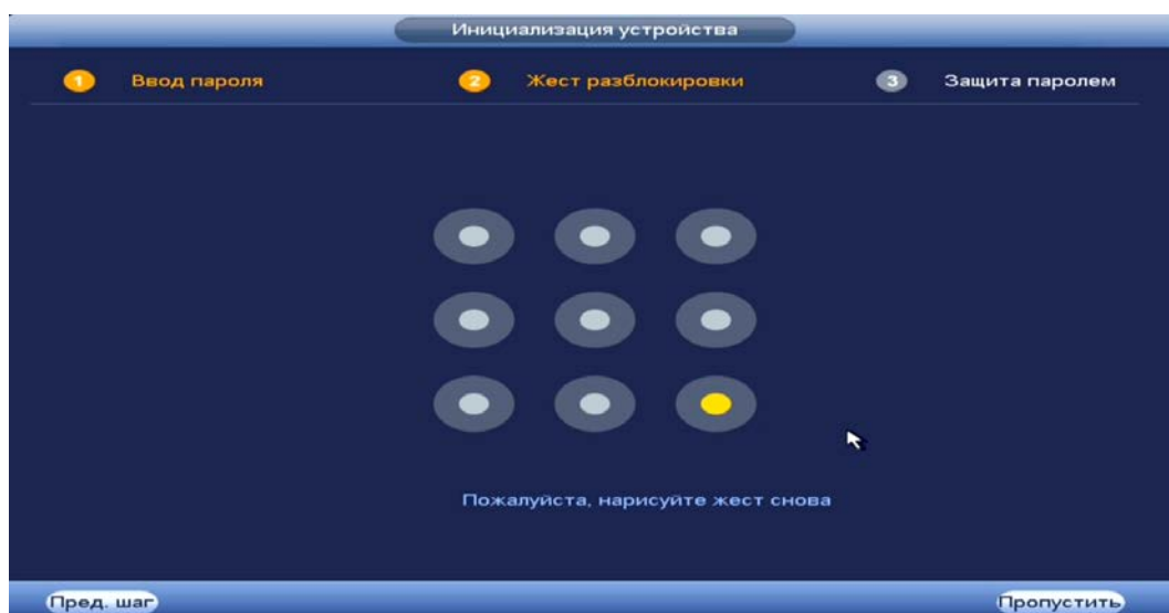
Рисунок 4.2 – Инициализация устройства «Жест разблокировки»
