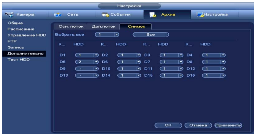
Рисунок 15.16 – Интерфейс выбора HDD для снимка
