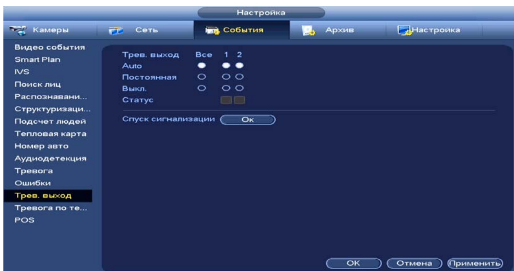
Рисунок 14.12 – Настройка записи по тревожному выходу
