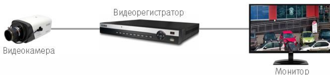
Рисунок 8.2 – Схема подключения видеокамеры
