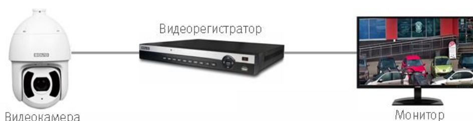
Рисунок 6.2 – Схема подключения видеокамеры
