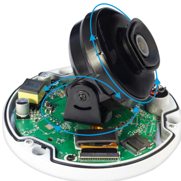
Рисунок 5.7 – Настройка направления объектива
