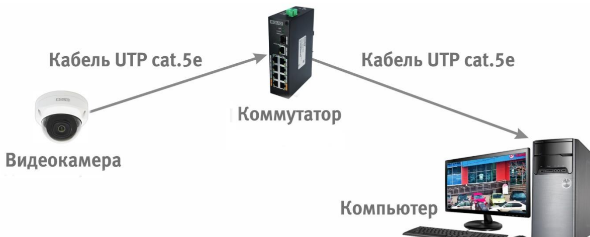
Рисунок 6.3 – Схема подключения видеокамеры к компьютеру через коммутатор
