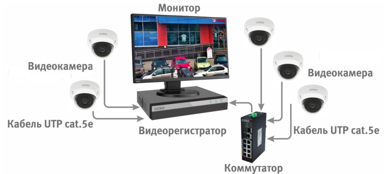
Рисунок 6.4 – Схема подключения видеокамеры к видеорегистратору
