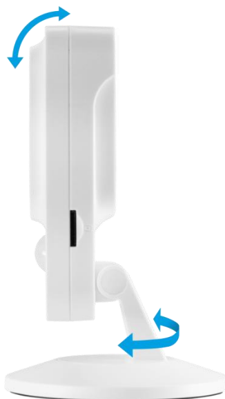
Рисунок 5.3 – Настройка направления объектива
