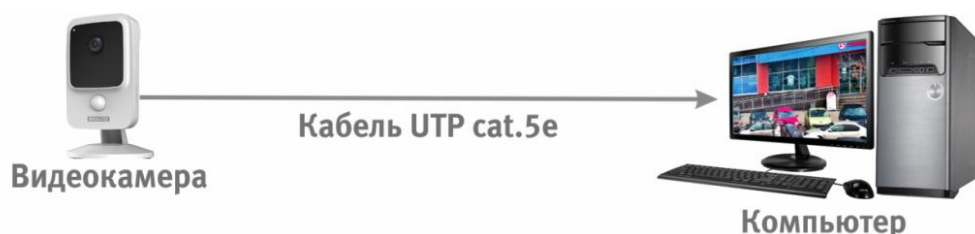
Рисунок 6.2 – Схема подключения видеокамеры к компьютеру
