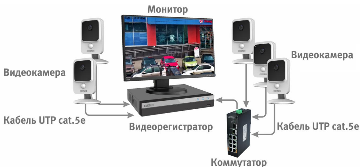
Рисунок 6.5 – Схема подключения видеокamеры к видеорегистратору
