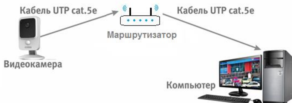
Рисунок 6.3 – Схема подключения видеокамеры к компьютеру по Wi-Fi
