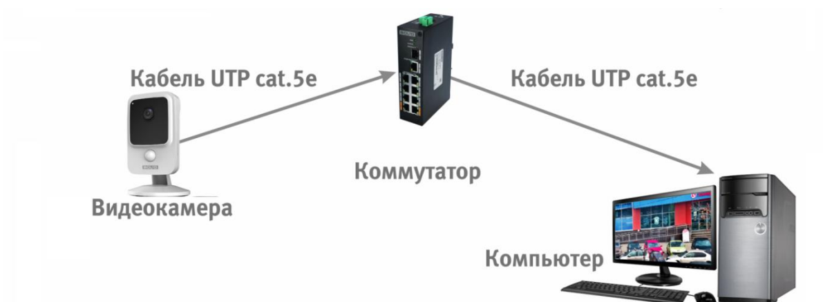
Рисунок 6.4 – Схема подключения видеокamеры к компьютеру через коммутатор
