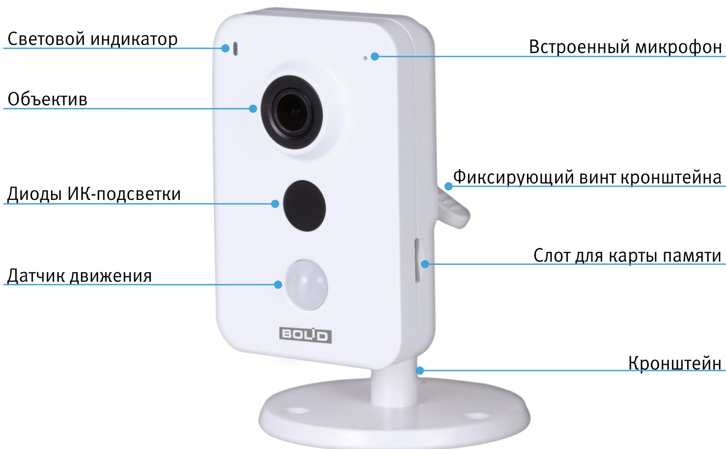
Рисунок 4.1 - Внешний вид и основные элементы видеокамеры
