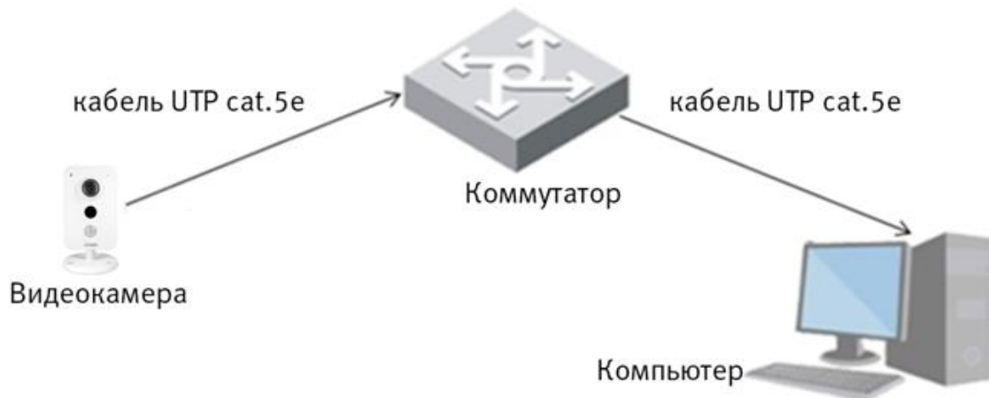
Рисунок 6.3 - Схема подключения видеокамеры к компьютеру через коммутатор
