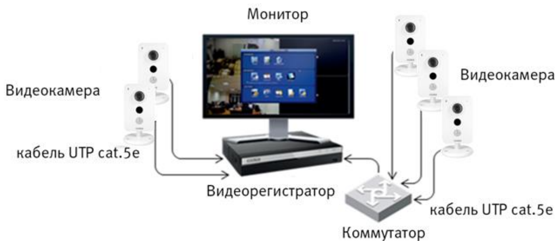
Рисунок 6.4 – Схема подключения видеокамеры к видеорегистратору
