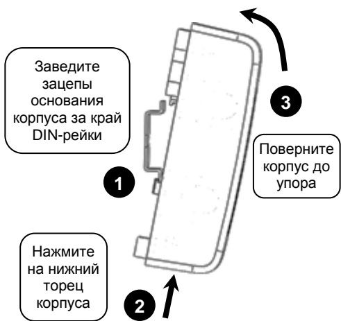
Рисунок 3. Крепление модуля на DIN-рейку
