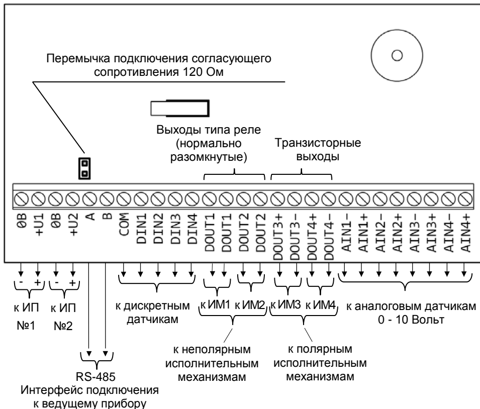
Рисунок 4. Схема внешних соединений модуля
