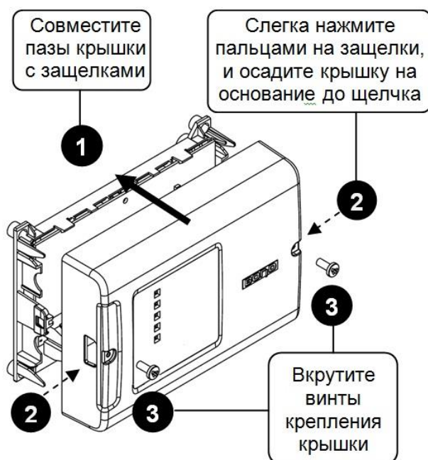
Рисунок 6. Монтаж крышки
