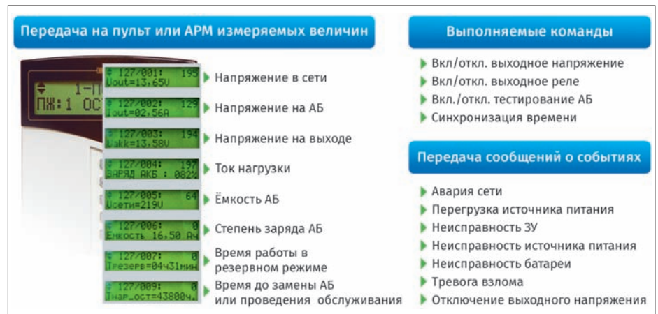
Рис. 1. Передача РИП событий и измеренных данных на пульт С2000М или АРМ "Орион Про" по интерфейсу RS-485
